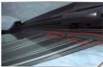
Cracked blade Poröses Wischgummi
