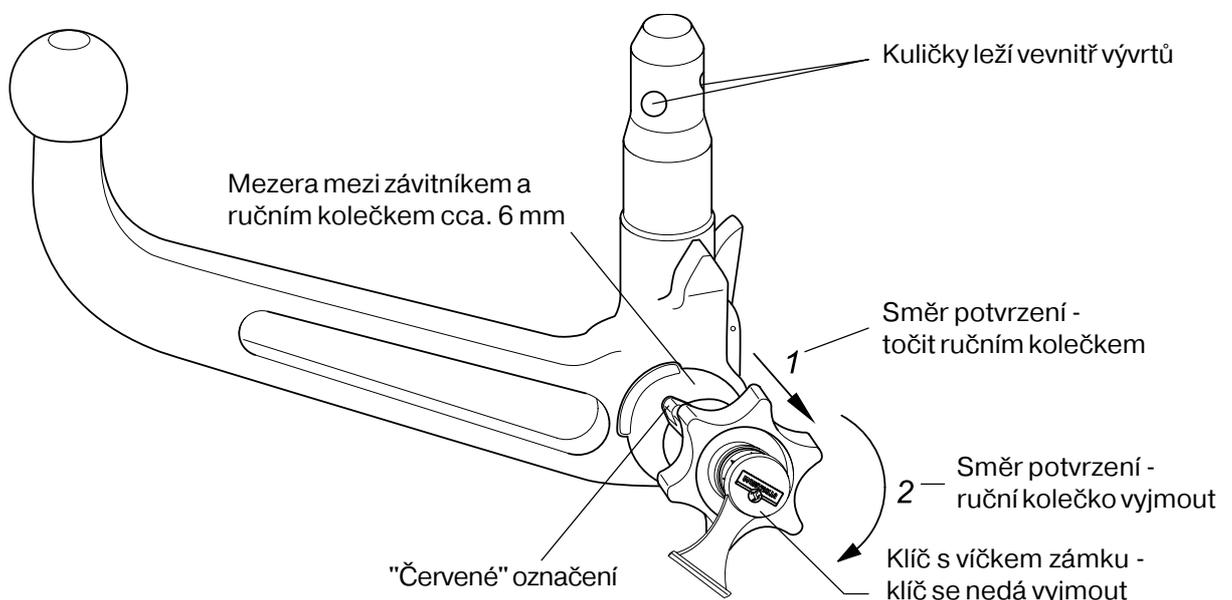
Tilladelsesnummer iflg. retningslinie 94/20/EU: **e13 00-1088**Klasse: **A50-X** Type: **305 221**Tekniske specifikationer: Maksimal D-værdi: **12,5 kN**Maksimal støttelast: **95 kg****Anvendelsesområde:** Køretøjsfabrikant: **Audi**Model: **A8**Typebetegnelse: **4E**
