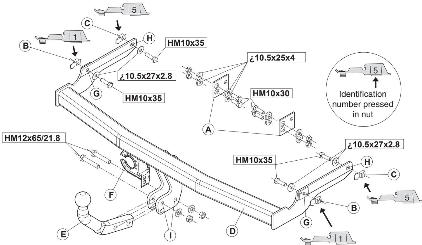
1. Verwijder het reservewiel. Zaag het in figuur 1 aangegeven gedeelte uit vanaf het midden van de bumper. Verwijder het uiteinde van de uitlaatdemper en het hitteschild, indien aanwezig. Maak de bumpersteun en aan de onderkant van de bumper los en klap deze naar beneden.
